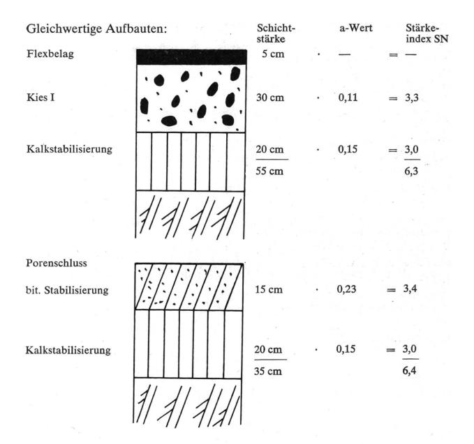
Die zweite Variante gilt vor allem für Strassen ohne Schneeräumung. Um diese Standarddimensionierungen überhaupt verwirklichen zu können, müssen leistungsfähigere Mischgeräte entwickelt werden, die die Herstellung von Kalkstabilisierungen mit einer Schichtstärke von 20 bis 25 cm erlauben.
