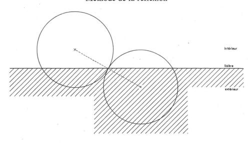
Cette méthode suppose des limites rectilignes, ce qui ne peut pas être le cas puisque le peuplement est au mieux polygonal. En dehors des angles il pourra donc être nécessaire de «rectifier» les limites artificiellement. Mais que faire au voisinage des angles?
