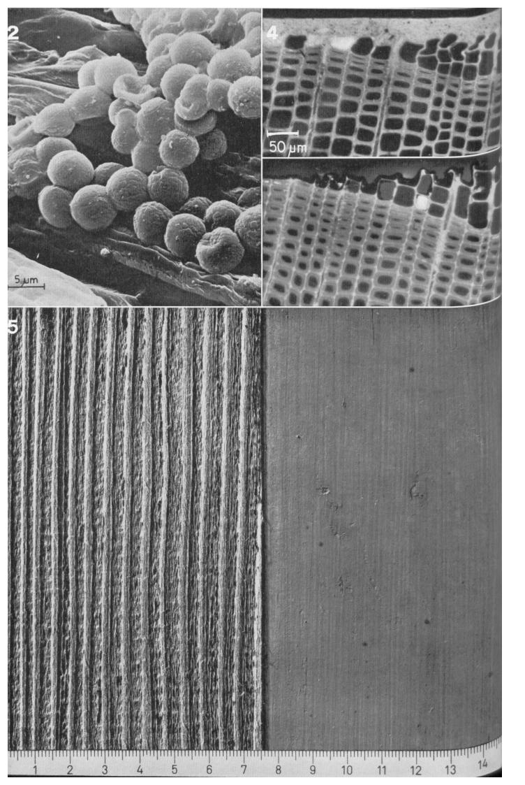
eine Haltbarkeit an senkrechten, stark dem Wetter ausgesetzten Nadelholzfassaden von über 5 Jahren zugesprochen werden kann (Bild 5).
