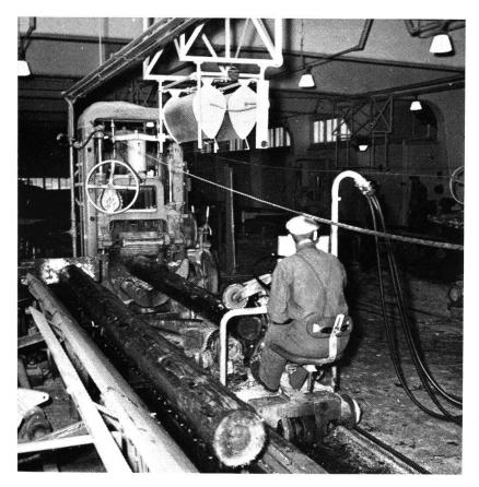
Abbildung 7 Um 1950. Der Säger fährt auf dem Spannwagen
