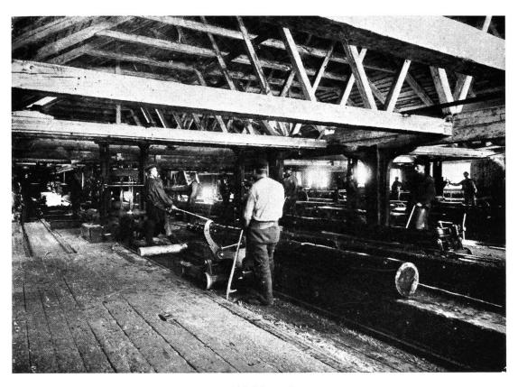
Abbildung 6 Um das Jahr 1897. Der Säger geht hin und zurück mit dem Spannwagen
