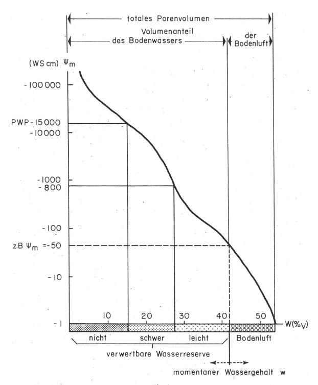
Fig.~4 Abhängigkeit des Wassergehaltes w (%), der Wasserverwertbarkeit und des Luftanteils von der Saugspannung -p bzw. vom Matrixpotential  $\Psi_{\rm m}$
