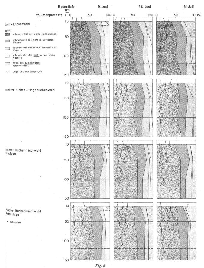
Volumenanteile der festen Bodenmasse, der Bodenluft, des leicht, schwer und nicht verwertbaren Bodenwassers an drei bestimmten Tagen der Vegetationszeit
