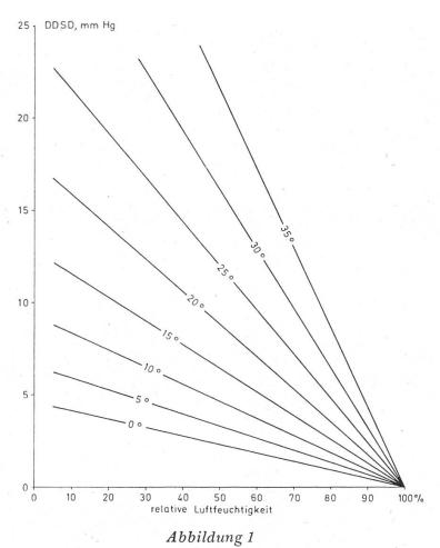
Zusammenhänge zwischen Temperatur, relativer Luftfeuchtigkeit und Dampfdrucksättigungsdefizit (DDSD).
