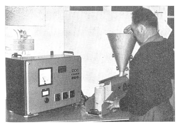
Fig. 10 DK-Meßgerät.
