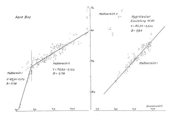
Darstellung 2 Elektrische Trockengehaltsmessung, Eichkurven für Buchen-Sägespäne Versuch Ekingen II
