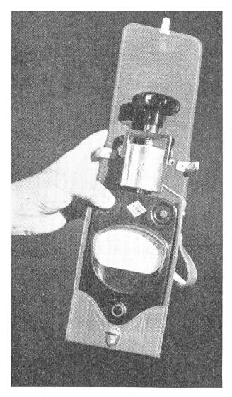
${\it Fig.\,9}$  Widerstandsmeßgerät mit Becherelektrode.
