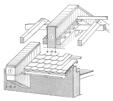
Abbildung 5 Brandmauer Typ A, über Dach geführt.
