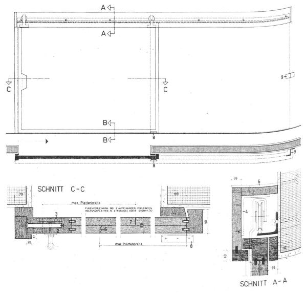
$Abbildung \, \tilde{\textbf{4}}$  Feuerhemmende Schiebetüre aus Holzspanplatten 60 mm.
