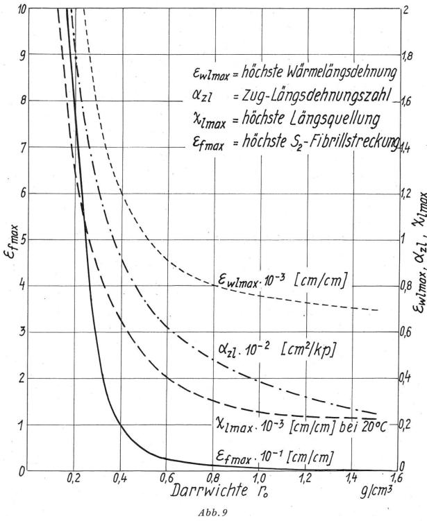
Zusammenhang zwischen thermo-, hygro-, mechanoelastischer Dehnung und höchster S2-Fibrillstreckung der Holzfasern in Abhängigkeit von der Darrwichte der Hölzer
