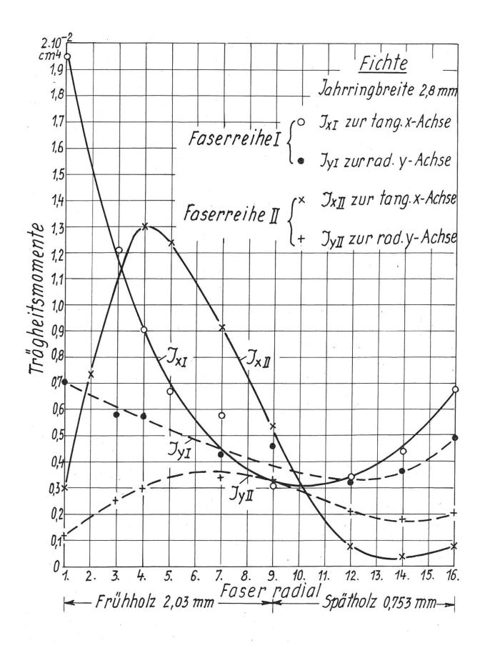
Abb.4 Verlauf der radialen  $(J_{xI}, J_{xII})$  und tangentialen  $(J_{yI}, J_{yII})$  Trägheitsmomente der Querschnitte von zwei (I, II) radialen Faserreihen von Fichte
