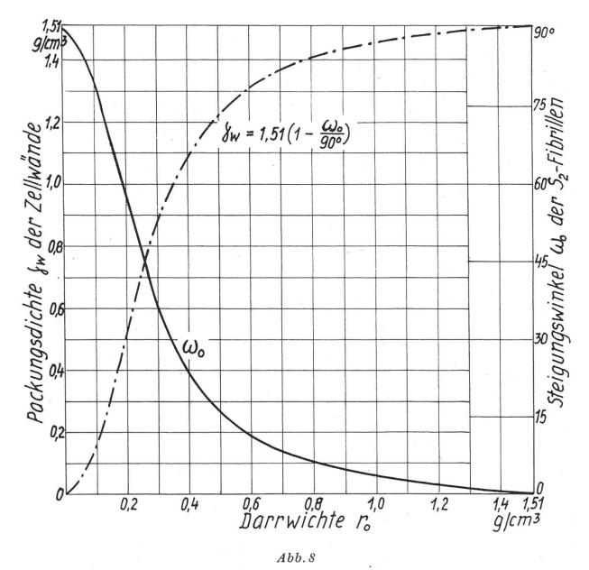
Beziehung zwischen der Darrwichte  $r_0$  der Hölzer, der Packungsdichte  $\gamma_w$  der Zellwände und dem Steigungswinkel  $\omega_0$  der  $S_2$ -Fibrillen
