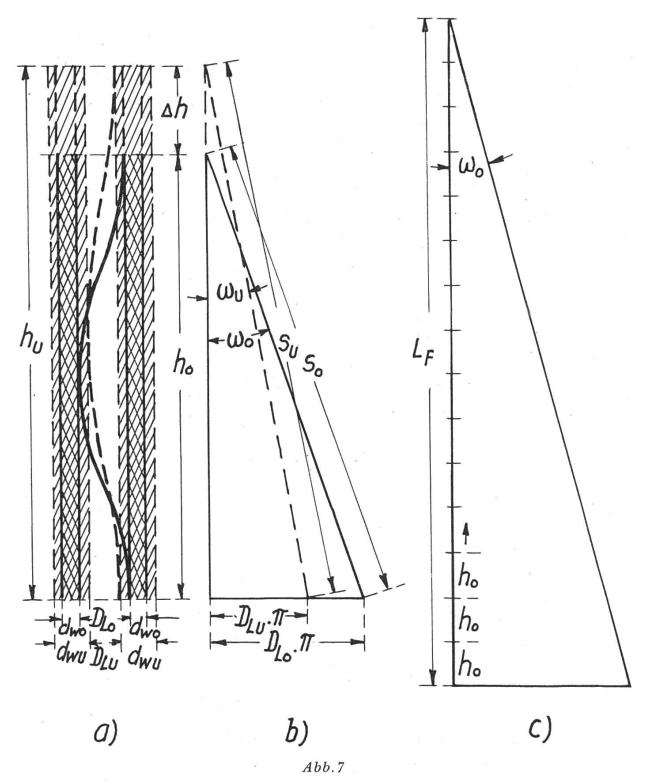
Analytisch-mathematische Beziehungen zwischen den Größen der Faserbauelemente sowie mit der Faserlänge (c)
