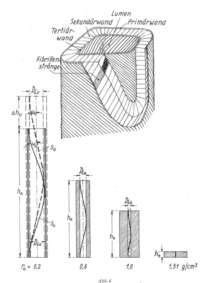
Spiraliger Bau der Holzzellwände (oben) und Steigungswinkel der Sekundärwandfibrillen in Abhängigkeit von der Darrwichte der Hölzer und der Feuchte (unten bzw. links)
