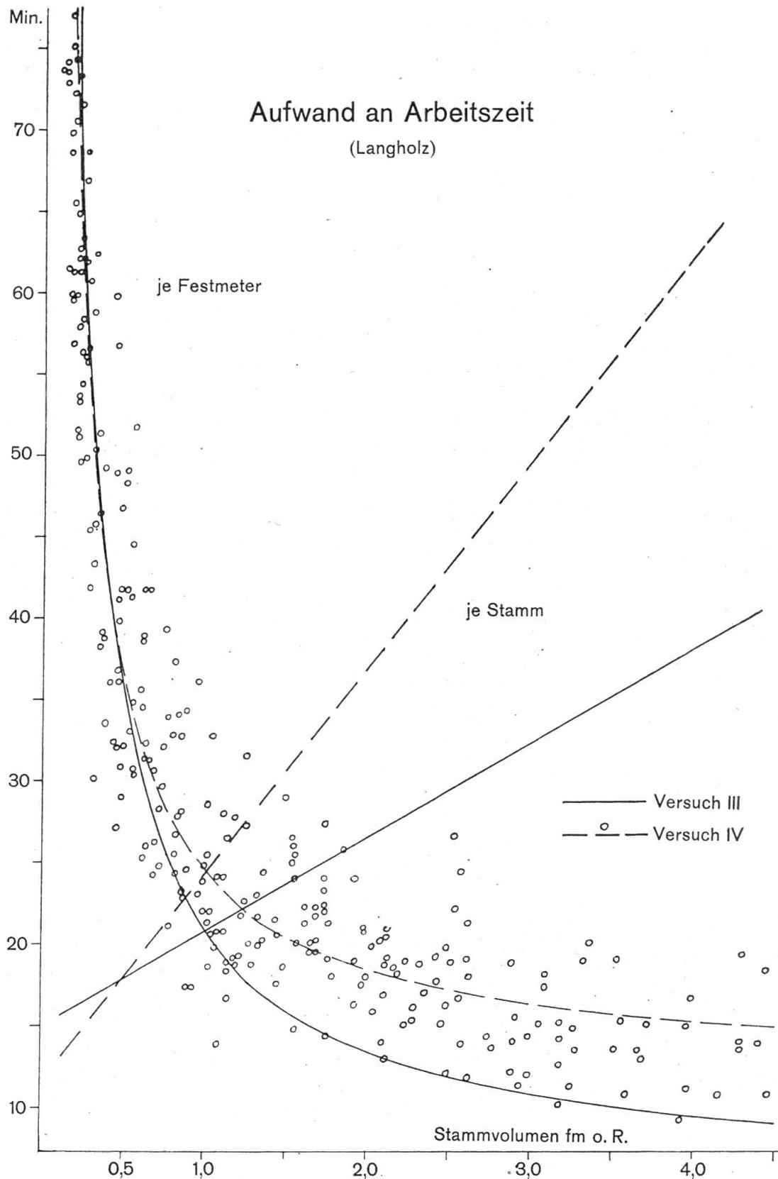
Arbeitszeitaufwand je  $m^3$  Rundholz in Abhängigkeit vom Stamminhalt auf dem Rundholzplatz. Während bei Stämmen von  $0,5 m^3$  zwischen 30 und 40 Minuten pro  $m^3$  aufgewendet werden, sinkt der Zeitbedarf bei Stämmen von  $2,0 m^3$  auf weniger als 15 Minuten in einem Betrieb mit Kran und auf etwa 18 Minuten bei Handarbeit. Unterhalb  $0,5 m^3$  nimmt der Zeitbedarf progressiv zu
