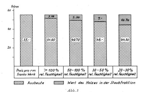
Relativer Wert von Holz verschiedenen Feuchtigkeitsgrades bei Zerspanung mit Hombak ZOA/PRZ 28 (nach H.D. Löffler).
