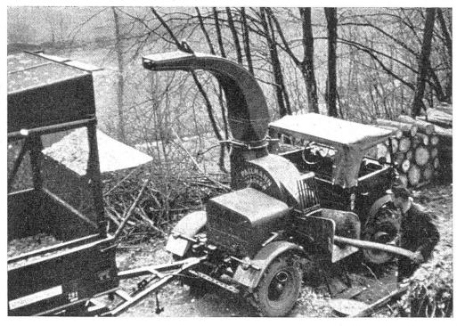
Abb. 17 Mobiler Hacker auf Unimogchassis für Holz bis etwa 20 cm  $\varnothing$ .
