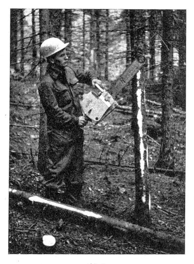
Abb.6 Entastung von schwachem Nadelholz mit Motorsäge am stehenden Baum bis auf eine Höhe von etwa  $1,5~\mathrm{m}$ .
