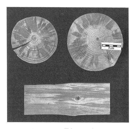
$Abb.\, {\it 1}$  Rotstreifigkeit an Fichtenholz. Stammquer- und Längsschnitt.
