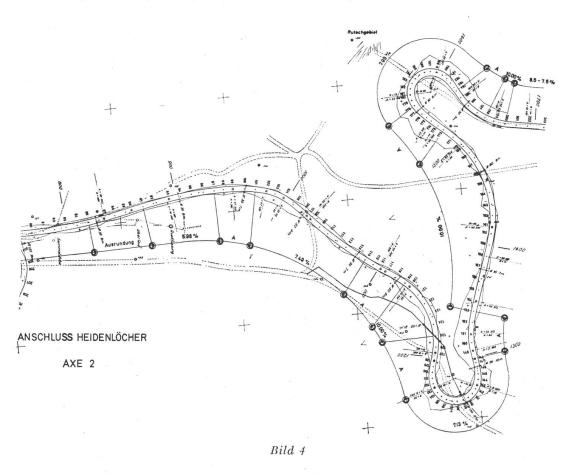
Maschine ohne Unterbruch durchgerechnet. Auch die Absteckung erfolgte reibungslos mit Hilfe zweier Reduktions-Tachymeter, wobei trotz guter Bestockung des Waldes etwa 85 Prozent der Punkte durch Einschneiden hergestellt wurden. Die Verpflockung hielt sich genau an die vorher festgelegten Toleranzen (seitliche Abweichung Axe—Null-Linie).
