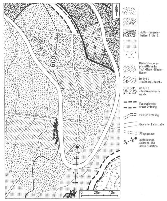
Schließlich muß vor Beginn der eigentlichen Arbeiten in der Aufforstungsprojektfläche die reibungslose Heranführung von Arbeitskräften und Arbeitsmitteln gesichert sein. Hierzu wurde für die Aufforstungsfläche «Monte Baro» ein transportabler Seilaufzug mit Hilfe vorfabrizierter, demontierbarer Stützen erstellt, welcher die Verbindung des Arbeitszentrums der Aufforstungsfläche mit der nächstgelegenen Fahrstraße herstellte.
