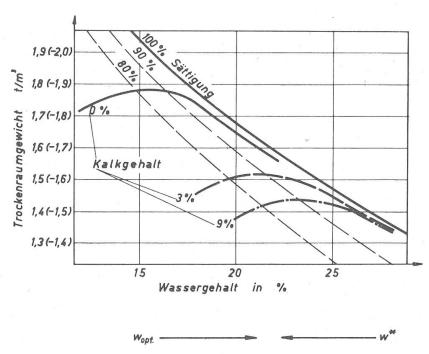
w<sub>opt.</sub> = optimaler Wassergehalt für die Verdichtung w<sup>#</sup> = natürlicher Wassergehalt
