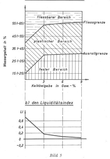
Weshalb die Plastizität infolge Kalkbeimischung in einem Boden kleiner wird und in einem andern gleich groß bleibt, ist noch nicht genau abgeklärt.
