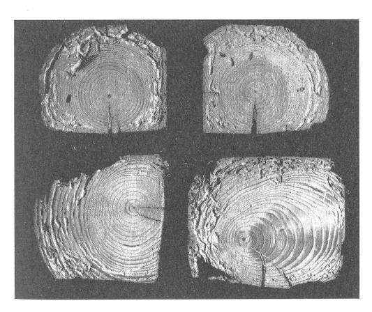
$Abb.\,4$  Balkenquerschnitte, deren Splintteile von Hausbocklarven stark zerfressen worden sind. (Aufn. EMPA-C, St. Gallen)
