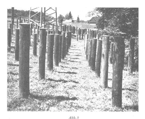
Versuchsfeld des VSE zur Prüfung von Stangenimprägnierungen in Rathausen bei Emmenbrücke. (Aufn. CKW, Luzern).
