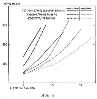
Höhenentwicklung beschirmter und unbeschirmter Fohren der Oberschicht auf vergleichbaren Standorten
