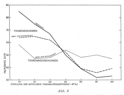
Qualität der Fohre und Streuung der Mittelhöhe in Fohren- und Fohrenmischdickungen
