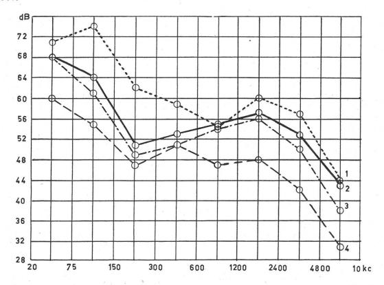
Frequenzanalysen des Schalls eines Magirus-Deutz-Diesels nach 100 m Schallausbreitung:
