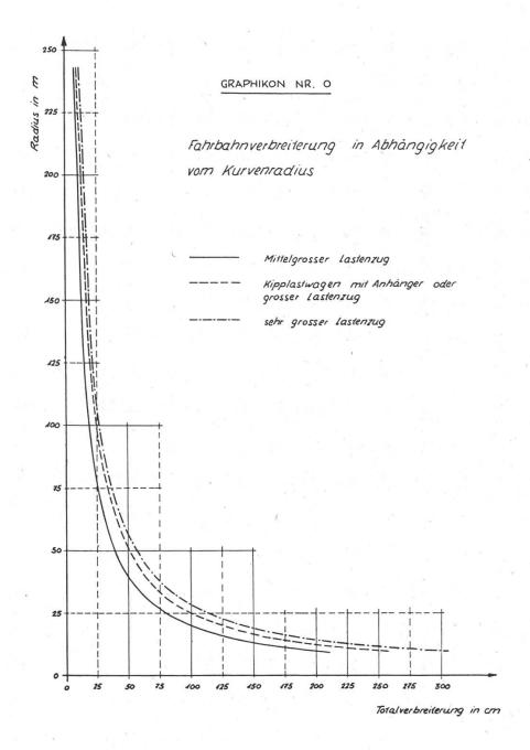
Aus den Tabellen und aus dem Graphikon ist ersichtlich, daß die Verbreiterungen größer sind, als meist angenommen wird. Selbst beim Radius von 50 m sind 40 bis 50 cm Fahrbahnverbreiterung nötig. Bei 30 m Radius sind sogar 70 bis 80 cm Fahrbahnverbreiterung nötig.
