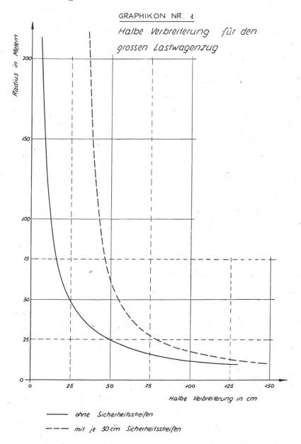
Die zulässige Wagenkastenbreite wird nach dem neuen Motorfahrzeuggesetz 2,50 m betragen. Nehmen wir für den Sicherheitsstreifen je 30 cm an, so muß in der Geraden ein Raumprofil von mindestens 3,10 m sein.
