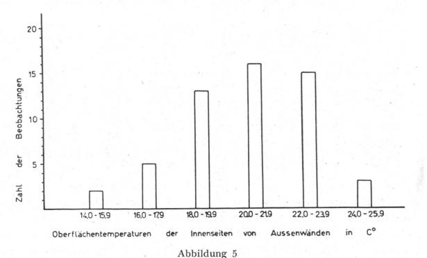
Die Oberflächentemperaturen der Innenseiten von Außenwänden im Winter in 54 Räumen von 28 Holzbauten
