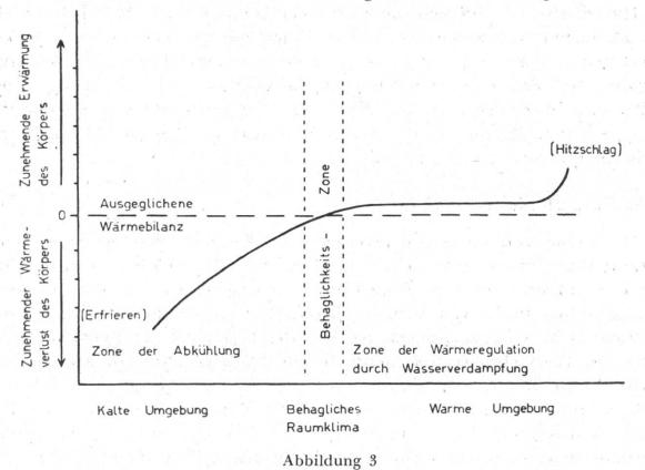
Schema des Wärmehaushaltes des Menschen unter verschiedenen Umgebungsbedingungen Die dick ausgezogene Kurve stellt die Wärmebilanz des menschlichen Körpers dar, die nur in einem verhältnismäßig engen Temperaturbereich ausgeglichen ist.
