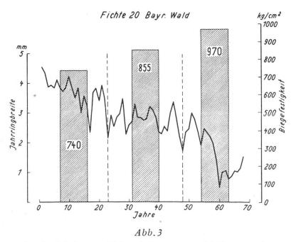
Biegefestigkeit von Fichtenholz aus verschiedenen Teilen eines Stammabschnittes
