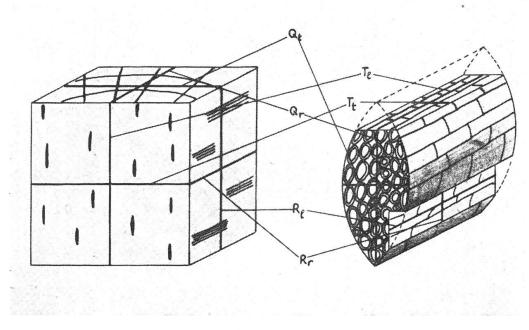
Abbildung 2 Meβ-Schema für Schwindungsuntersuchungen.
