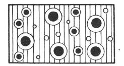
Emulsion directe de bitume. Oil-Water gouttelette d'eau possède dans l'intérieur un globule de bitume fortement grossie
