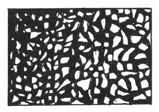
Mortier bitumeux gros de la bande de roulement grosseurs de grains silicieux 3 à 5 et 5 à 8 mm — type: papier de verre
