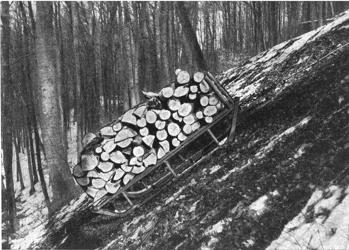
Rücken von Schlachtholz mit Pontonschlitten «Schwyn»; Lastgang mit 1,8 Ster am Hang von 80 % Neigung. Zugmittel: Seilwinde.
