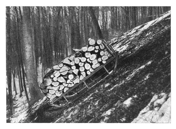
Rücken von Schichtholz mit Pontonschlitten «Schwyn»; Lastgang mit 1,8 Ster am Hang von  $80\,^{0}/_{0}$  Neigung. Zugmittel: Seilwinde.
