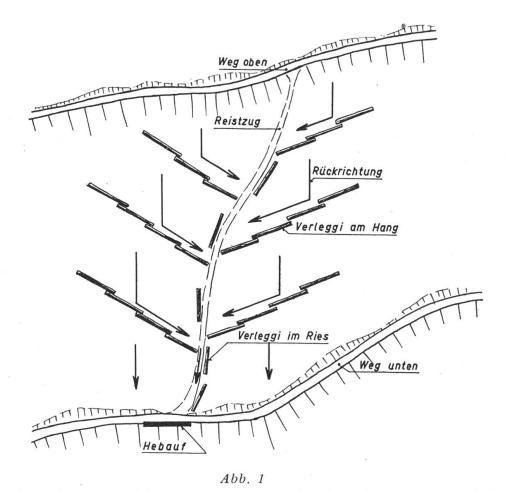
Schlagfläche im Bereiche eines Reistzuges mit eingezeichneten Bauwerken
