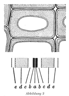
Querschnitt durch Nadelholztracheiden: a) Mittellamelle; b) Primärwand; c) Außenschicht; d) Mittelschicht und e) Innenschicht der Sekundärwand (aus Kerrund Bailey, 1934)
