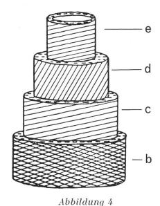
Schema der verschiedenen Wandschichten einer Faser (n. Preston): b Primärwand mit gekreuzten Fibrillen, c Außenschicht, d Mittelschicht und e Innenschicht der Sekundärwand mit parallelen Fibrillen
