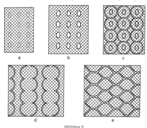
Schema des Wachstums und der Tüpfelbildung von Gefäßwänden. Zellachse †
