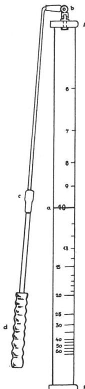
Der neue, modifizierte Hypsometer ist 50 cm lang und arbeitet mit einer Latte von 5 m Länge. Der Maßstab hängt an einem Handgriff, der in allen Richtungen beweglich ist. Dieser Handgriff ermöglicht eine künstliche Armverlängerung und damit größeren Abstand des Maßstabes vom Auge, so daß man mit einem so langen Maßstab aus der Hand arbeiten kann. Die Teilstriche der Skala sind wegen der Länge von 50 cm größer und dadurch viel übersichtlicher und präziser als bei dem ursprünglichen «Christen».
