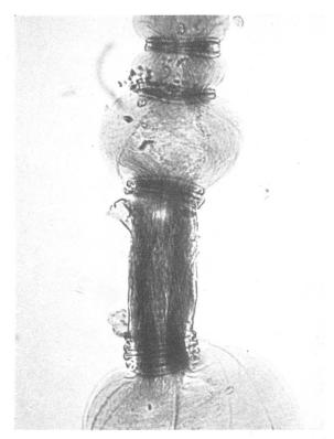
Abb. 14  $$270\times$$  Kugelquellung von Holzfasern
