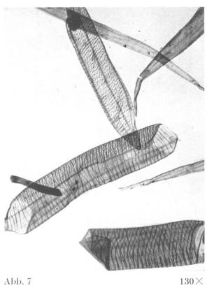
Lindenfasern; Gefäße mit schraubenförmiger Wandverstärkung
