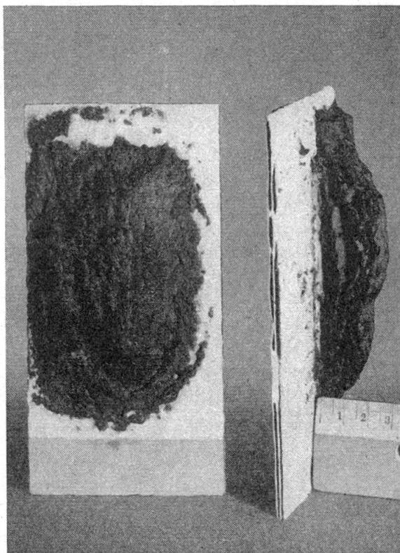
tenden unbrennbaren Gase verdünnt und in ihrer Brennbarkeit herabgesetzt; kommen sie schließlich doch noch zur Entzündung, so brennen sie nicht auf der Oberfläche der Holzfaserplatte, sondern auf der des schwer verbrennlichen, wärmedämmenden Schaums. Es sind also mindestens vier physikalisch-chemische Vorgänge, die sich unter Überlagerung und gegenseitiger Unterstützung der Inbrandsetzung der Platte entgegenstellen.
