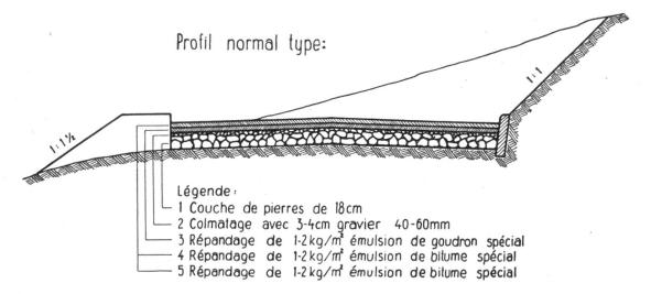
Pour obtenir une surface rugueuse et antidérapante surtout en côte, où le profil en long accuse des fois une pente assez forte, on pourrait prévoir à la place du gravier de 5/8 mm un gravillonnage avec un grain silicieux plus fort, p. ex. de 15 à 25 mm, concassé avec adjonction de sable pour bonne fermeture de la surface traitée.
