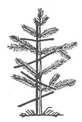
Das Gerät besteht aus zwei umeinander gedrehten Drähten, in die je nach Länge mehr oder weniger Querstacheln eingearbeitet sind. Die ganze Ausführung entspricht also ungefähr einem Stück Stacheldraht, bei dem jedoch die Stacheln mindestens 10 cm lang sind. In der Praxis hat sich erwiesen, daß im allgemeinen drei Größen benötigt werden:
