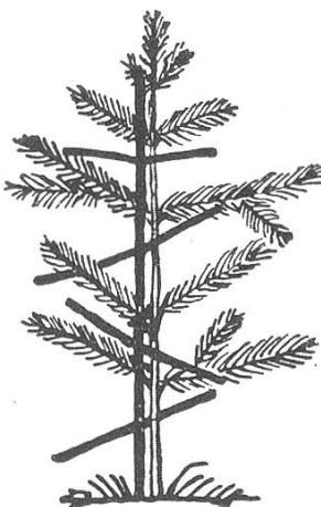
Das Gerät besteht aus zwei umeinander gedrehten Drähten, in die je nach Länge mehr oder weniger Querstacheln eingearbeitet sind. Die ganze Ausführung entspricht also ungefähr einem Stück Stacheldraht, bei dem jedoch die Stacheln mindestens 10 cm lang sind. In der Praxis hat sich erwiesen, daß im allgemeinen drei Größen benötigt werden:
