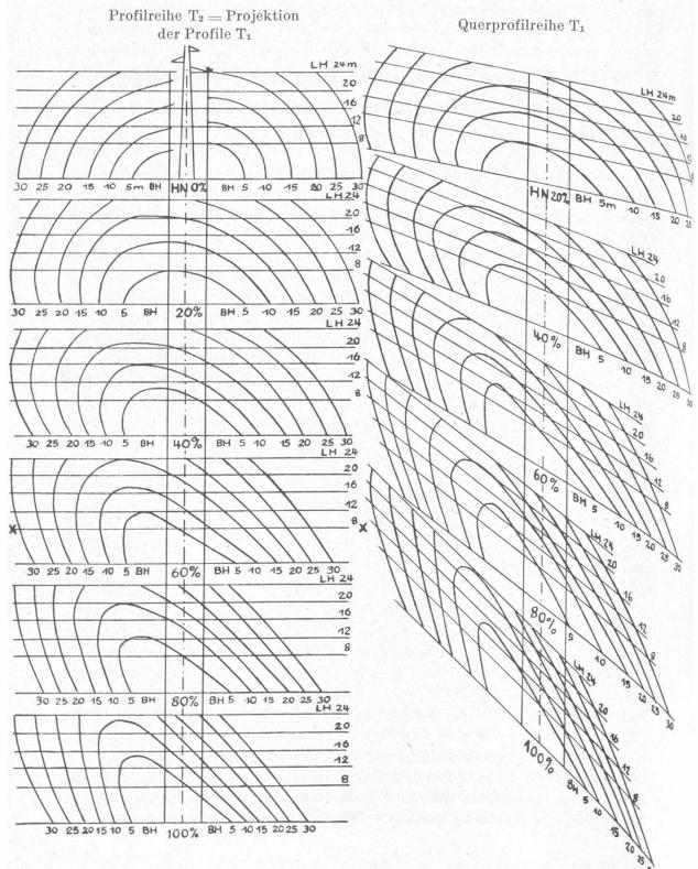
Leitung zulässigen Baumhöhen, abgestuft von 5 m zu 5 m, ermittelt. Die Zonen dieser Baumhöhenstufen wurden im Situationsplan eingetragen und ihre Fläche berechnet. Die zulässige Baumhöhe richtet sich in erster Linie nach der Höhe des untersten Leiters, die für jeden Geländepunkt aus dem Längenprofil des Leitungsprojektes entnommen werden kann, und nach der Hangneigung, die sich aus dem Waldplan errechnen oder im Gelände direkt messen läßt.
