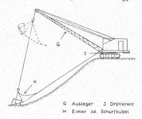
Die Leistung des Baggers ist vorwiegend von dessen Größe und der Bodenart abhängig. Bei Behandlung der Straßenbauausführung wird darauf näher eingegangen.
