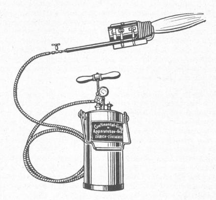
Schematisches Bild eines tragbaren Starkbrenners der « Continental » Licht- und Apparatebau AG. in Dübendorf-Zürich
