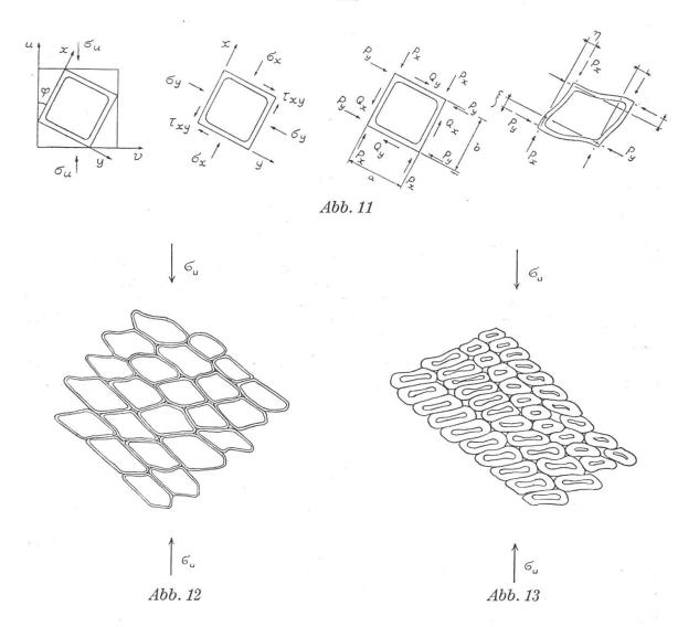
dung dafür gefunden, warum Spannungen und Verformungen für  $0^{\circ} < \varphi < 90^{\circ}$  auch bei kleinen Laststufen nicht proportional zueinander sein können. Auch der Verlauf der Festigkeitskurve Abb. 4, die sich theoretisch aus zwei Ästen zusammensetzt, ist nun grundsätzlich leicht erklärlich.
