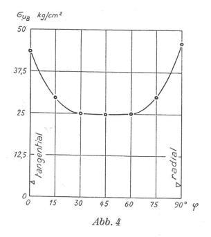
In Abb. 4 sind die Prismendruckfestigkeiten  $\sigma_{uB}$  von Prismen  $2.5 \times 2.5 \times 7.5$  cm aus Rottannenholz mit einem Darrgewicht  $r_o = 0.43$  t/m³ und bei einer Feuchtigkeit w = 13.3% für verschiedene Winkel  $\varphi$  zwischen Druckrichtung u und tangentialer Richtung x auf-
