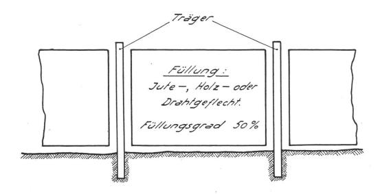
Schematische Darstellung eines Zaunes für den Schneerückhalt.
