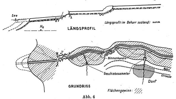
Flußeindämmung, Schema (Gesamtverbauung mit Beeinflussung des Flußregimes)
