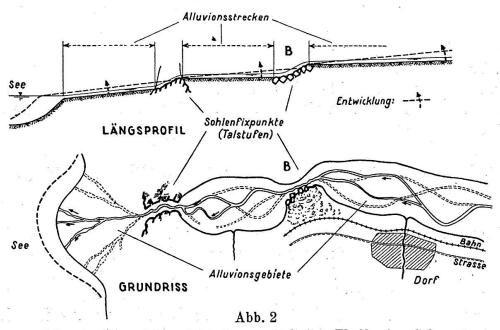
Längsprofil und Grundriß eines natürlichen Flußlaufes (Schema)
