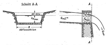
Abb. 1. Abflußsektion und Abfluß über die Sperrenkrone.
