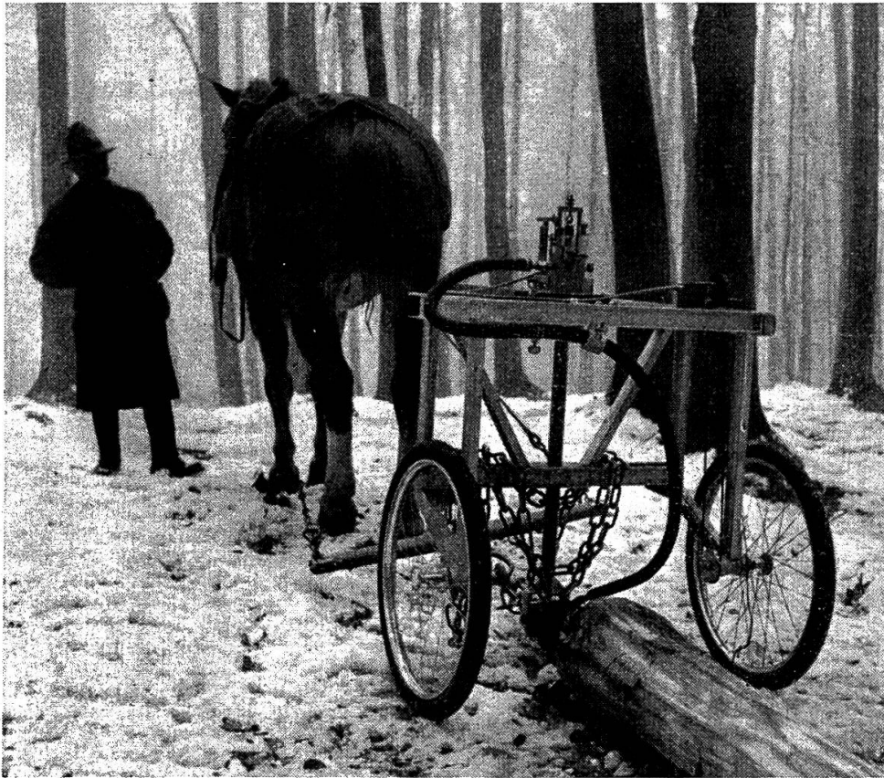
Bild 2. Zugkraftmessung beim Rücken mit Hilfe eines Meßwagens zum Mitführen des Registriergerätes, mit automatischem Vorschub der Diagrammrolle in Abhängigkeit vom zurückgelegten Weg.
