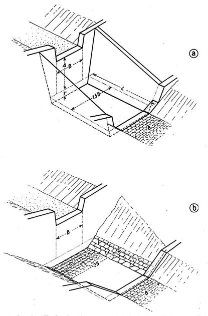
Abb. 3. Anzustrebende Tosbeckenformen, a) bei fester Seitenwandung, b) mit natürlichen Böschungen.
