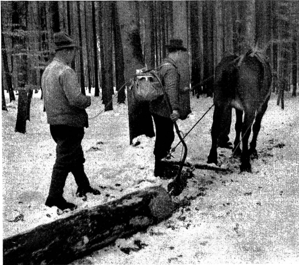
Bild 1. Zugkraftmessung beim Rücken durch Mittragen des Registriergerätes und Bedienung des Vorschubmechanismus der Diagrammrolle von je einem Mann.
