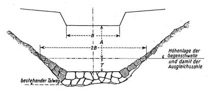
Abb. 4. Einpassen des Tosbeckens in das bestehende natürliche Talquerprofil.
