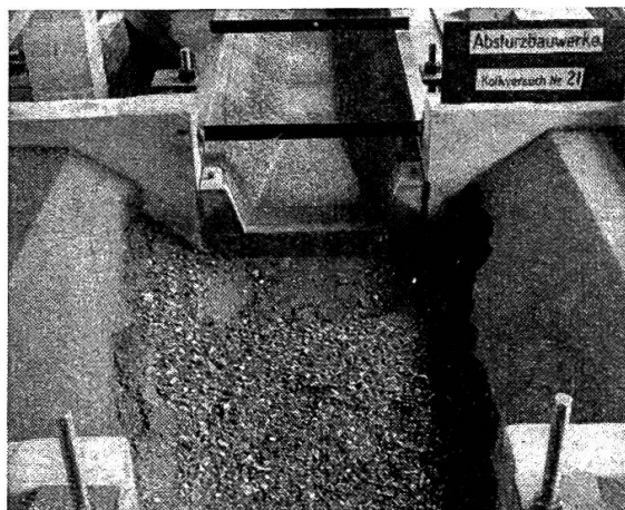
Abb. 6. Selbsttätige dreidimensionale Kolk-(Tosbecken-)Ausbildung beim reinen Überströmen, Photo aus Versuchen.
