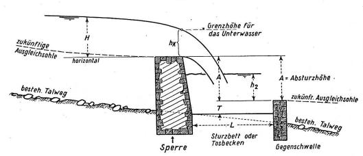
Abb. 2. Abflußvorgang bei der noch nicht verlandeten Sperre mit Tosbecken.
