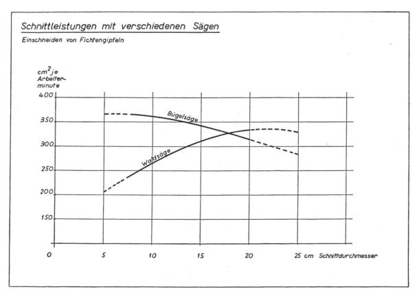
Zeichnung veranschaulicht, nahmen mit steigendem Durchmesser die Schnittleistungen je Arbeiterminute bei der Bügelsäge ab, bei der Waldsäge zu. Im vorliegenden Fall scheinen Wald- und Bügelsäge im Durchschnitt bei ungefähr 18 cm Schnittdurchmesser gleiche Leistungen aufzuweisen.
