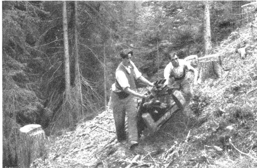
Aufwärtstransport auf dem Schlitten mit Motorzug.
