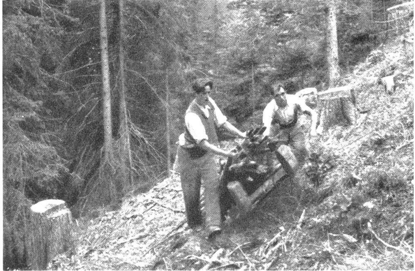
Aufwärtstransport auf dem Schlitten mit Motorzug.
