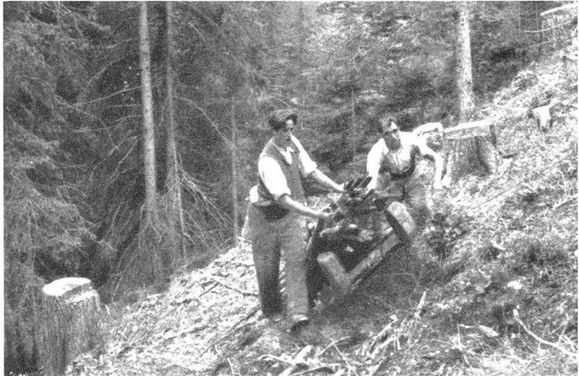
Der Zugmotor « Motrac ». Im Hintergrund der ankommende Schlitten. Das Zugseil läuft über zwei ob dem Weg befestigte Rollen.
