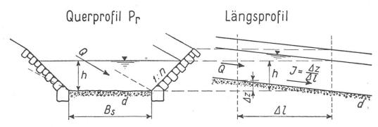
Abb. 1. Querprofil und Längsprofil eines Gerinnes.
