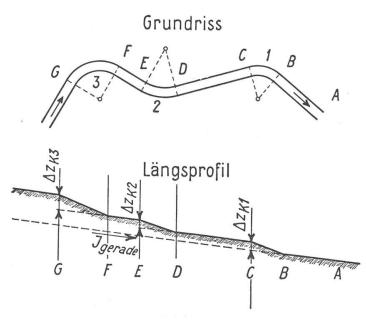
Abb. 8. Längsprofil eines Flußlaufes mit Krümmungen im Beharrungszustand bei konstanter Profilbreite.
