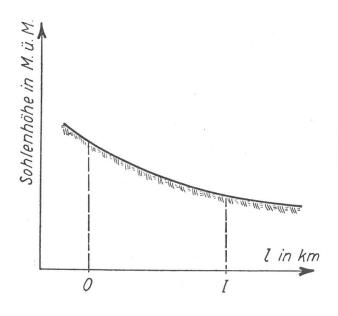
Abb. 7. Längenprofil im Beharrungszustand bei konstantem Querprofil.
