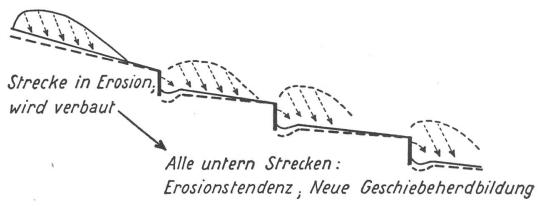
Abb. 13. Wirkung der Verbauung einer Teilstrecke in Erosion. Untere Strecken erhalten Erosionstendenz. Ähnliche Wirkung haben: Geschieberückhaltesperren, Geschiebefänge, auch natürliche Ausbrüche mit Ablagerung des Geschiebes.
