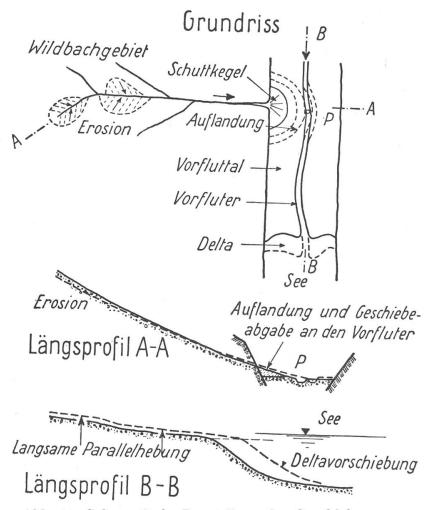
Abb. 11. Schematische Darstellung des Geschiebeweges.
