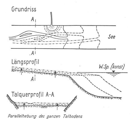
Abb. 9. Schematische Darstellung der natürlichen Verlandung der Vorfluttäler.
