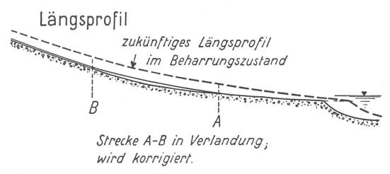
Abb. 12. Wirkung der Verbauung einer Teilstrecke in Verlandung, Auflandung der unteren Strecken, Parallelhebung der oberen.
