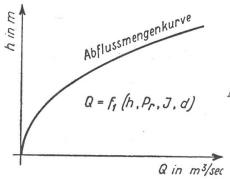
Abb. 2. Die Abflußmengenkurve.
