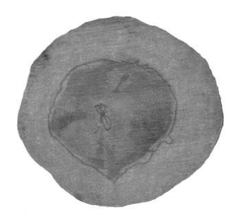
Bild 2. Großer Frostkern aus Lestrup Skov, Abt. 18. Einige Wochen alter Schnitt. Durchmesser des Stammes 47 cm, der des Kerns 30 cm.
