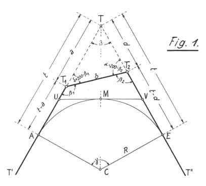
Es sei abgesteckt und gemessen worden der Polygonzug T' $T_1T_2T''$  mit den Winkeln  $\beta_1$  und  $\beta_2$  und der Polygonseite  $T_1T_2 = b$ . Dann ist:
