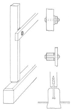
Bild 11. Silobau der Schenkung Dapples Konstruktionseinzelheiten.
