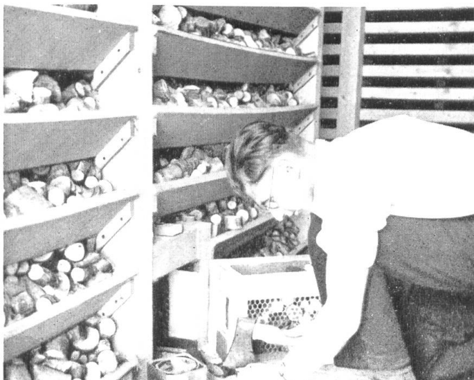
Bild 7. Eingebaute Drahtgitterschubfächer gestatten die Entnahme von Holzproben aus dem Innern der Silos zur Bestimmung des Wassergehaltes.
