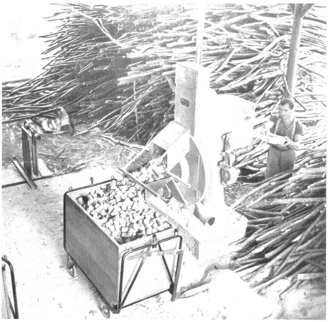
Bild 6. Die automatische Jonneret-Kreissäge schneidet etwa  $800-1000~\mathrm{kg}$  Gasholz in der Stunde.
