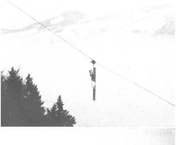
Bild 9. Die Last ist aufgezogen. Die Schere des Laufwagens hat sich wieder geschlossen, so dass die Greifvorrichtung eingeklemmt ist. Die beiden Wagen sind entkuppelt. Der Laufwagen mit der Last rollt durch Ausgabe von Förderseil talwärts.
