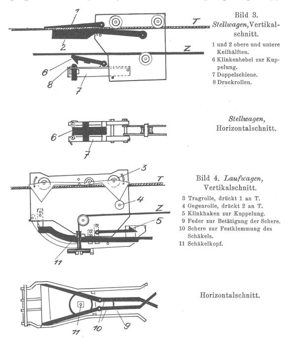
des Laufwagens auf die obere Keilhälfte (1) auf, so wird letztere an das Tragseil gedrückt. Gleichzeitig bewirkt (Bild 3 und 4) eine Gegenrolle (4) das Andrücken der untern Keilhälfte an T, wodurch der Stellwagen am Tragseil festgeklemmt wird. Ferner ist am Laufwagen der unbewegliche Klinkhaken (5) angelenkt. In diesen fällt ein (am Stellwagen nach oben schwenkbarer) Klinkenhebel (6) beim Anfahren des Laufwagens an den
