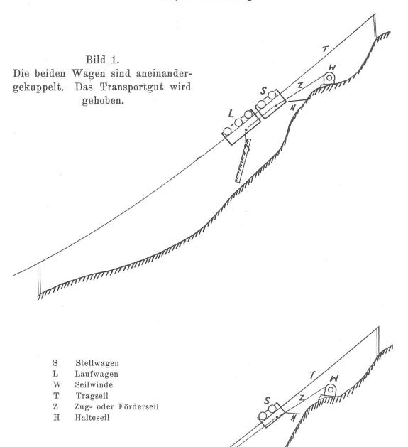
Bild 2. Durch den Lastaufzug wurden die beiden Wagen entkuppelt. Der Laufwagen befindet sich auf der Talfahrt. dem Tragseil (T) laufen. Diese Hilfseinrichtung wird mit dem Halteseil (H) über der zu hebenden Last festgehalten. Der Stellwagen klemmt den an ihn anfahrenden Laufwagen (L) mit einer selbsttätigen Kupplung fest. Diese kommt folgendermassen zustande: Der Stellwagen weist zwei gelenkig gelagerte Keilhälften (1 und 2) auf. Läuft nun die bergseitige Tragrolle (3)
