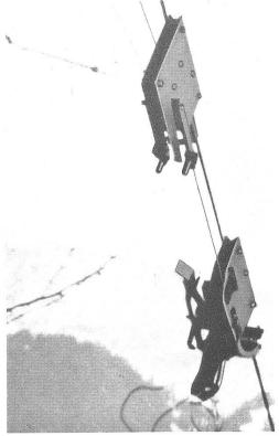
Bild 7. Der Laufwagen ist an den Stellwagen angefahren und gekuppelt worden.
