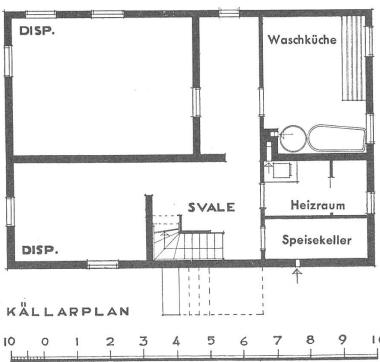
Bild 7. Grösserer Typ eines eingeschossigen Kleinhauses, gedacht für kinderreiche Familien. Das Kellergeschoss enthält zwei disponible Räume, von denen einer als Werkstatt, der andere als Garage einwerden gerichtet kann. Baukosten 1939: (hoher Bauindex) 14500 SKr.  $(1 \text{Ster} \sim 1 \text{SFr.})$
