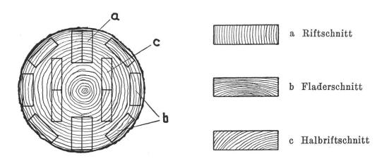
Die Riftstücke (a) enthalten sowohl äussere als auch innere, also im frischen Zustand sehr verschieden feuchte Holzteile, die Fladerstücke (b) dagegen enthalten fast nur äussere, also sehr feuchte Jahrringe, während die Halbriftstücke (c) mehr aus den innern, also verhältnismässig trockenen Teilen des Querschnittes stammen.
