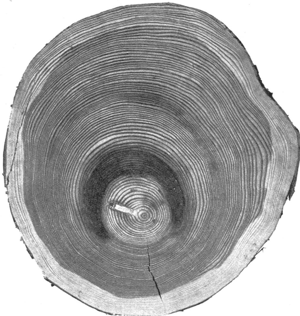
Der mechanischen Zerstörung des Holzes folgte eine Zerstörung durch den Pilz *Trametes pini*, der vermutlich vom Boden her in das gestauchte Holz eindringen konnte. Die Fäule umfasst nur wenige Jahrringe. Das gerüstete Brennholz fällt längs den Jahrringen auseinander.
