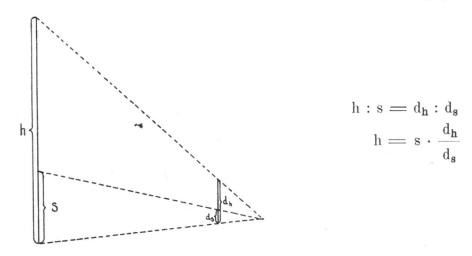
Nach dieser Proportion können bei der Konstruktion von Latten-Höhenmessern drei verschiedene Wege eingeschlagen werden:
